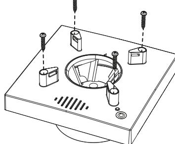
**3. Montez Waves dans l'ouverture du mur**
